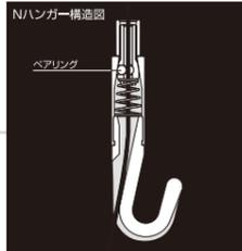
コレダーラインのハンガーには、ベアリング方式が採用されています。上方への移動は自由にできますが吊り下げられた作品の重さによって下方への力加わると、3個の銅球(ベアリング)が均一な力でワイヤを確実にロックするため、位置がずれることはありません。
