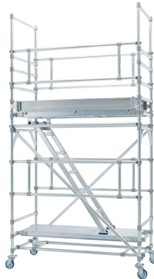
作業天場まで上がりやすい内階段を備えた中型サイズのローリングタワーです。特徴としては、作業床と手摺り、階段を組み替える事で、作業高さを3段階に変更する事ができます。組替えにより、展示室の天高、3.9m~4.4m程度の作業が可能となります。収納時は上枠手摺を外す事で、高さ2.2mとなりますので収納場所を選びません。
