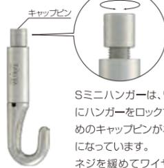
Sミニハンガーは、ワイヤにハンガーをロックするためのキャップピンがネジ式になっています。ネジを緩めてワイヤを挿入、高さを調節後キャップピンを締めてください。不意のアクシデントから事故を軽減します。
