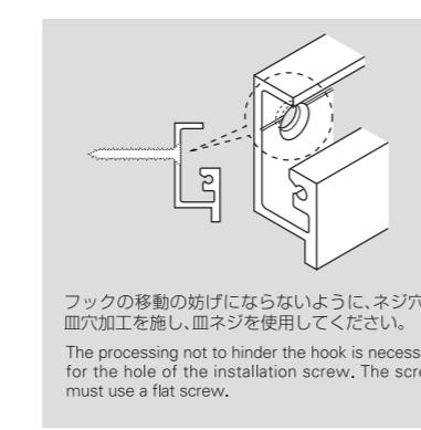
フックの移動の妨げにならないように、ネジ穴は皿穴加工を施し、皿ネジを使用してください。
