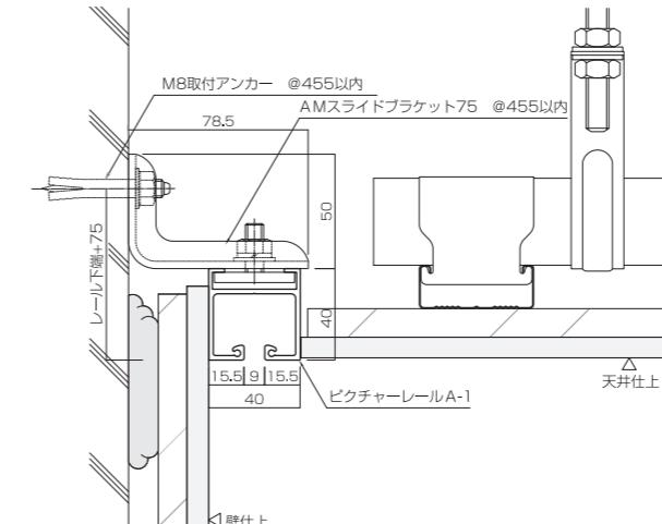
A - 1A モルタル仕上げ壁 取付例 Mortar wall
