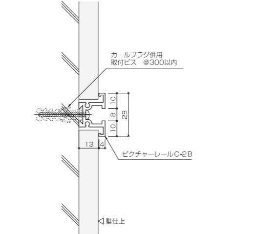
**C - 5** コンクリート壁 取付例 Concrete wall
