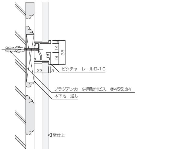
D - 1C 断熱壁 取付例 Insulation wall
