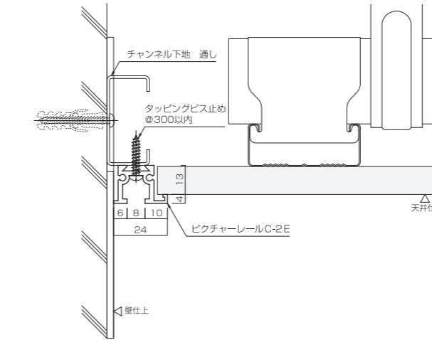
**C - 3A** モルタル壁 取付例 Mortar wall
