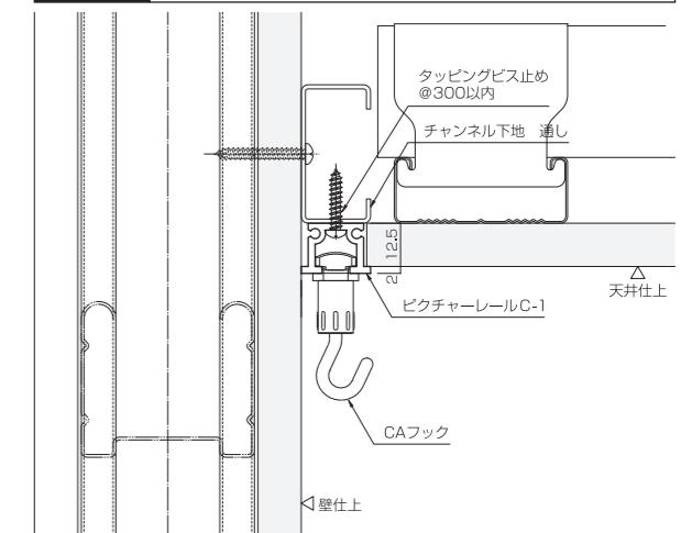
**C - 2S** 軽量鉄骨壁 取付例
