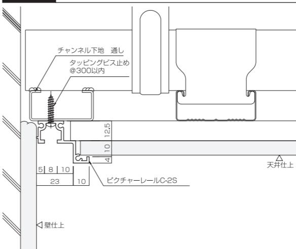
**C - 1A** 軽量鉄骨壁 取付例
