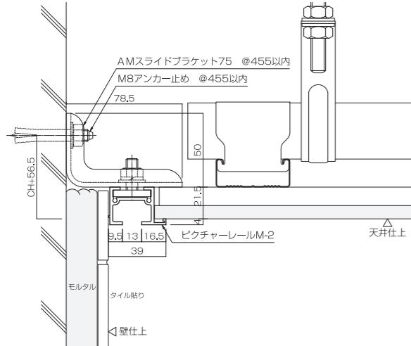
**M - 2** GL工法壁 取付例
