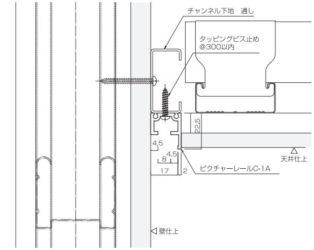
**C - 1** 軽量鉄骨壁 取付例
