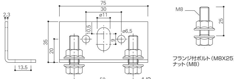
適応ネジ径 : 6mm
