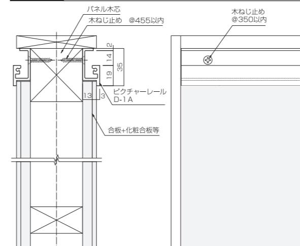
D - 1A モルタル壁 取付例 Mortar wall
