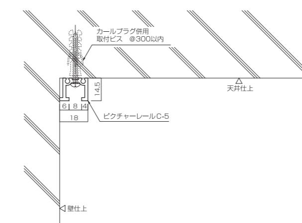
**C - 5** モルタル壁 取付例 Mortar wall
