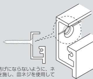
フックの移動の妨げにならないように、ネジ穴は皿穴加工を施し、皿ネジを使用してください。
