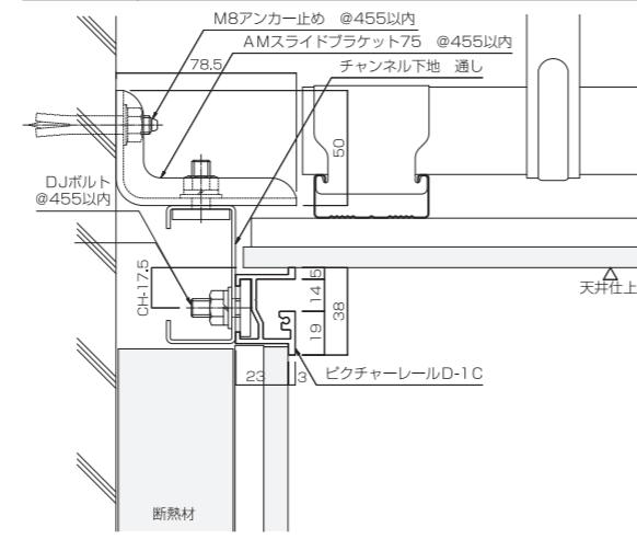
D - 1D モルタル壁 取付例 Mortar wall
