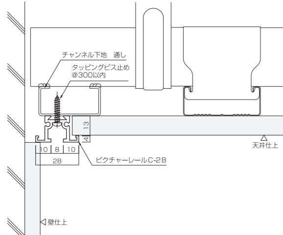
**C - 2B** モルタル壁 取付例 Mortar wall
