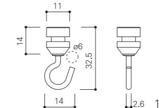
Kタイプレール適応フック This hooks adjustment for K type rails
