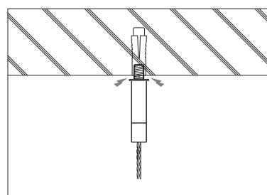
金具の方向（上下）が正しい事をご確認の上ご使用願います。逆方向に使用した場合、荷重を支えられない為、展示物が落下、破損し大変危険ですのでご注意願います。
