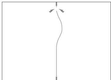
棚やハンガーパイプの取り付け後に商品や展示物を載せますと、荷重によりワイヤが若干伸びてワイヤが緩む事があります。その場合は再度ワイヤの締め付けを行ってください。
